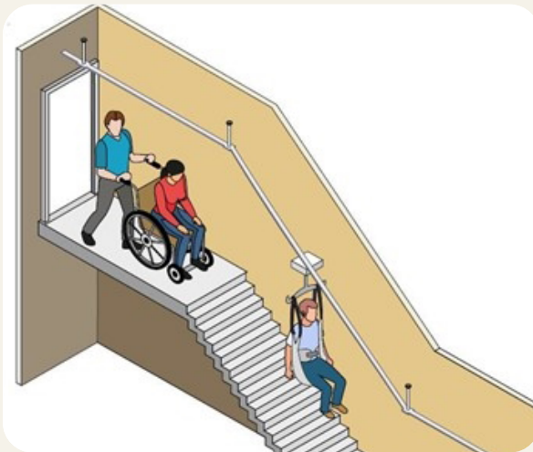
Рисунок 2.2. Схема влаштування стельового підймального пристрою
