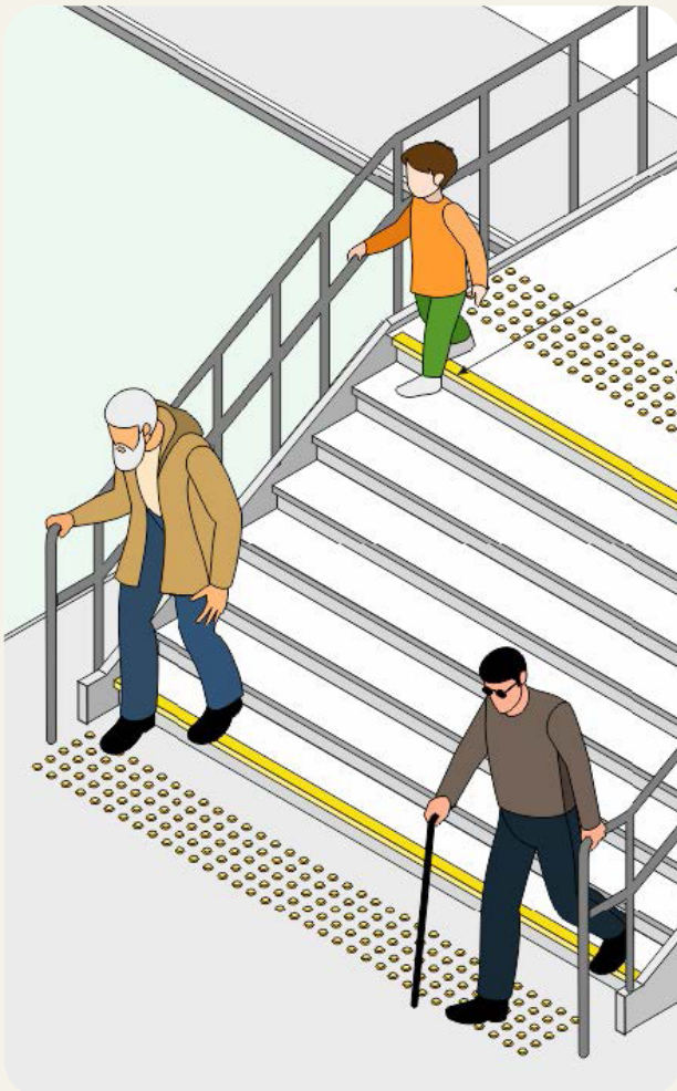
Рисунок 1.15. Приклад облаштування поручнів на сходах
