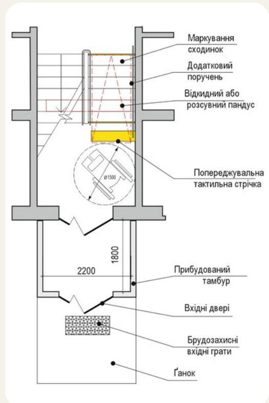
Рисунок 1.38. Схема адаптації входів до першого поверху в будинках типових серій
