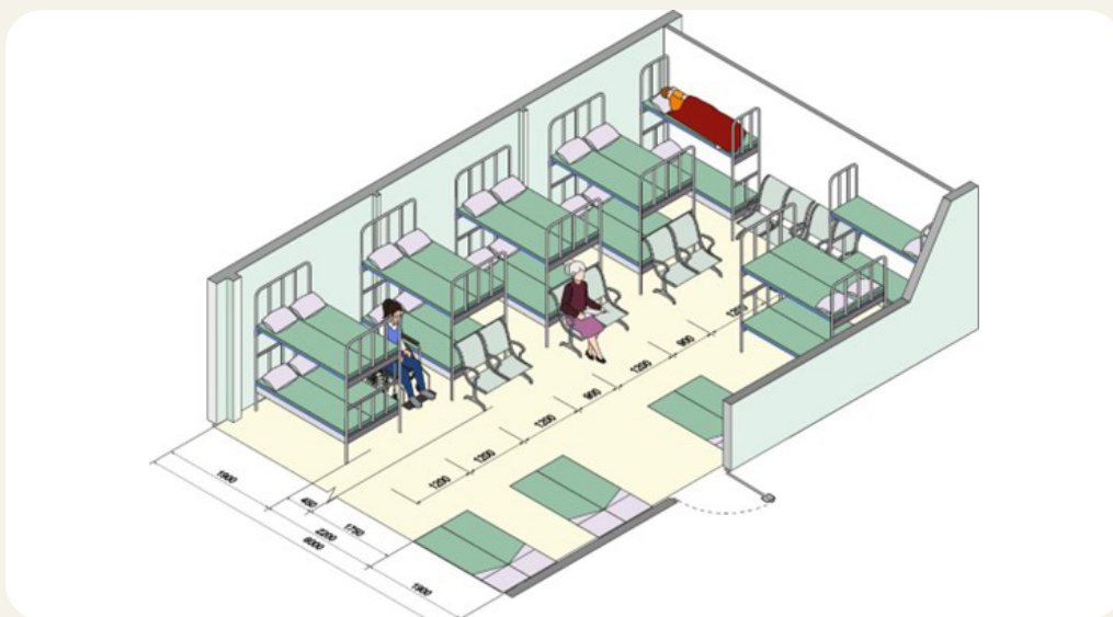
Рисунок 2.6. Схема облаштування укриття житлового будинку
