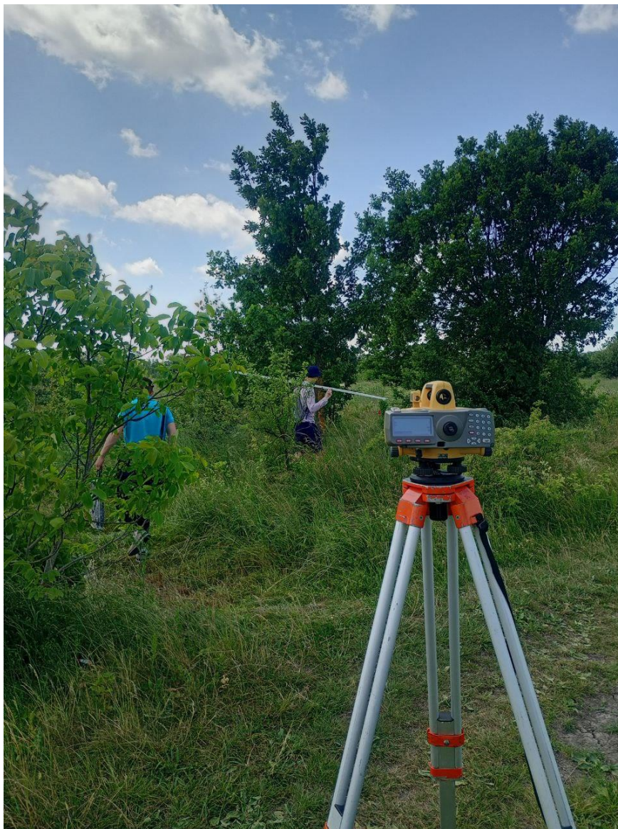
Рисунок 1.1 – Геометричне нівелювання коротким променем в с. Кропивник (дата спостережень – 18.06.2025 р.)
