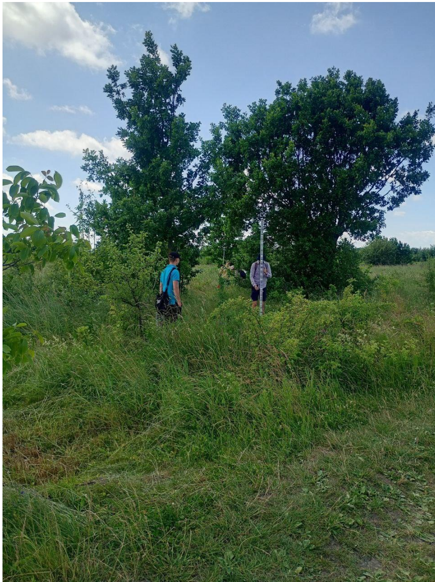
Рисунок 1.2 – Нівелювання коротким променем профільної лінії в с. Кропивник
