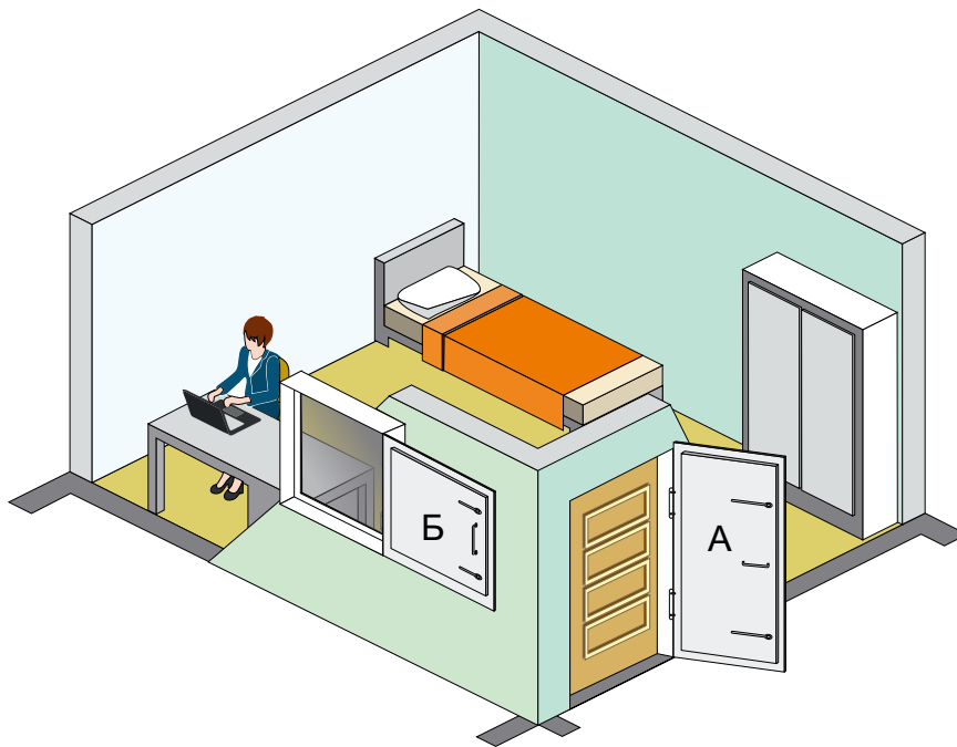
Рис. 34. Захищена кімната в квартирі: А, Б – додаткові захисні вікна і двері
