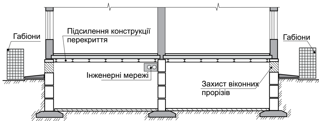
Рис. 22. Укриття в підвальному приміщенні цегляних будинків із залізобетонним перекриттям
