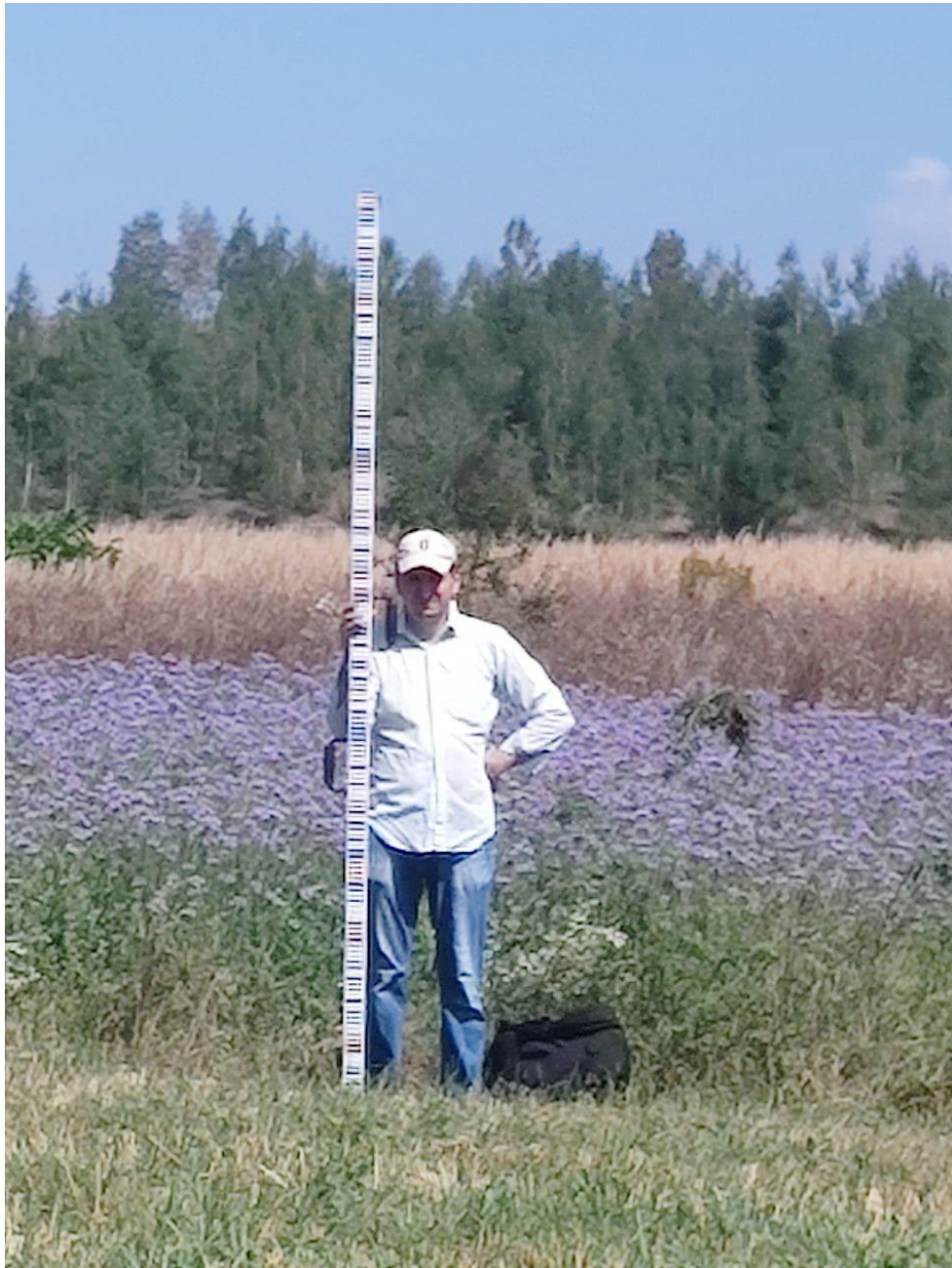
Рисунок 1.3 – Встановлення рейки на ґрунтовий репер 129 під час нівелювання в с. Кропивник
