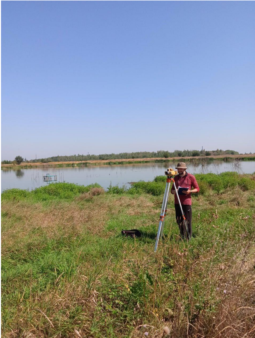
Рисунок 1.1 – Геометричне нівелювання коротким променем між ґрунтовими реперами в районі новоутвореного озера (с. Кропивник)
