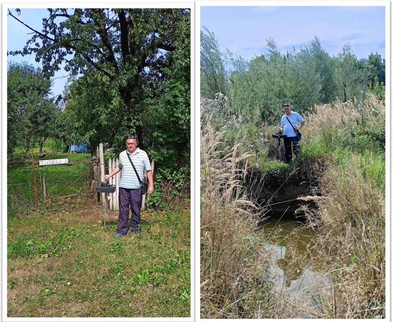
Рис. 2.3 – Виконання польових робіт в районі провалу 14 методом ПЕМПЗ, північно каїнітове поле, вул. Глібова.
