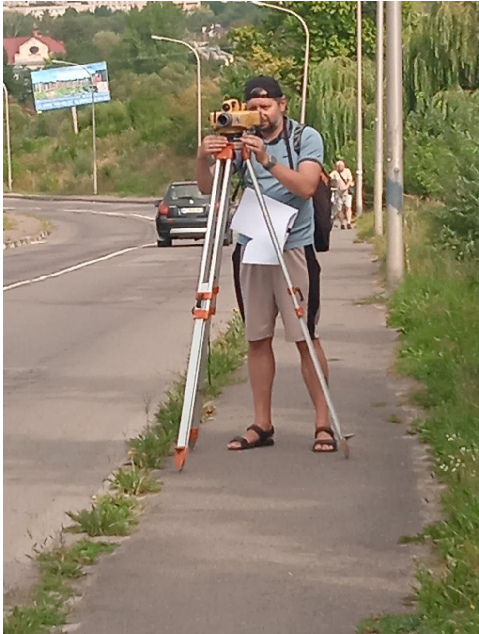
Рисунок 1.2 – Виконання серії нівелювання між реперами на вул. Європейська (дата спостережень – 16.08.2024 р.)
