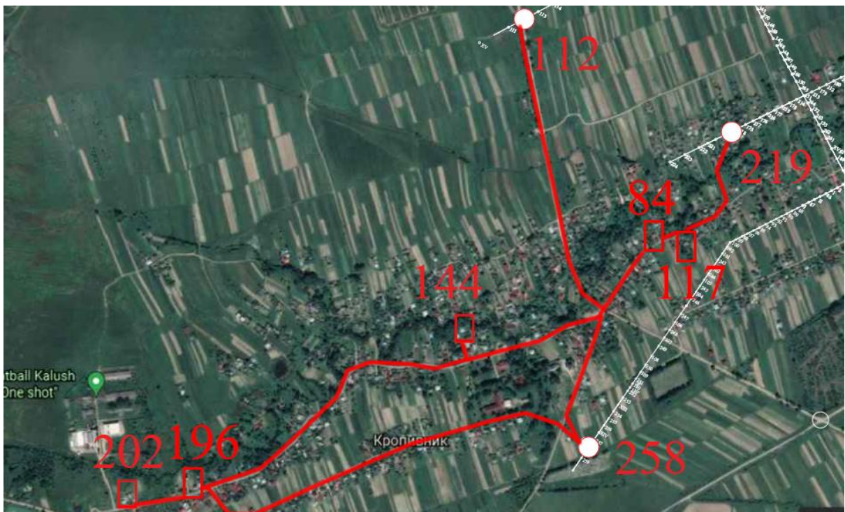
Рисунок 3.3 – Схема нівелірної мережі
