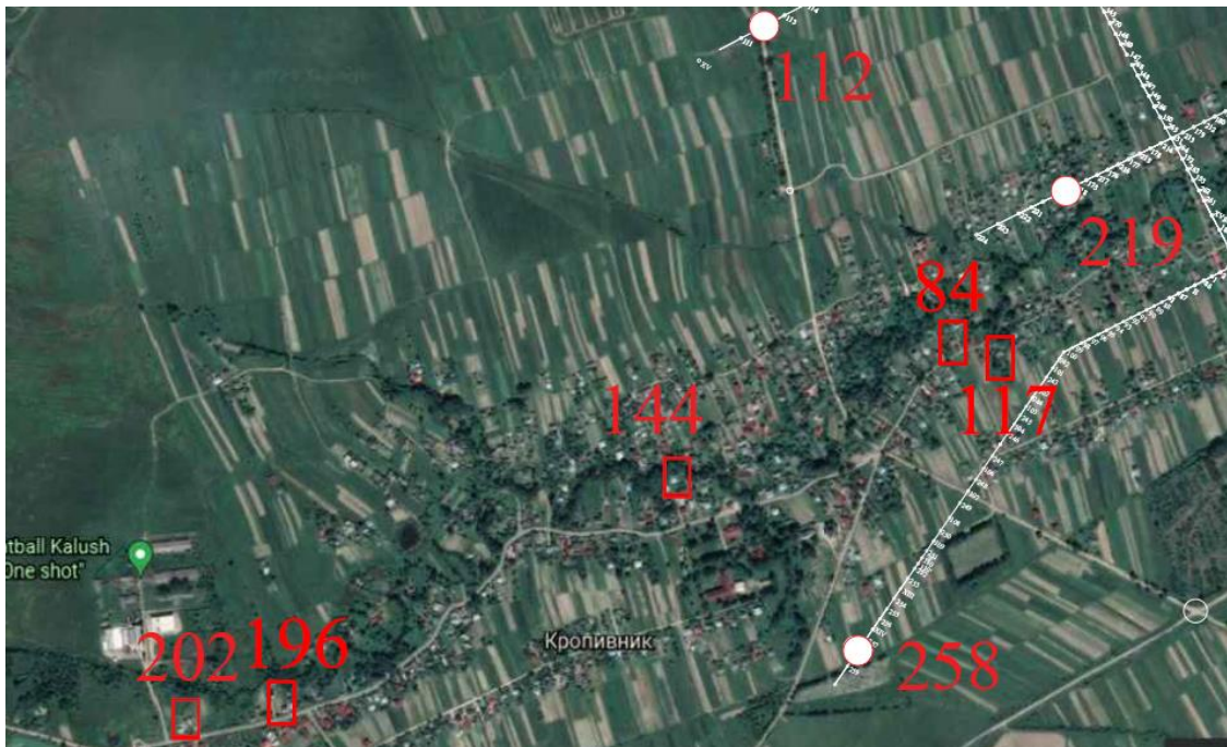
Рисунок 3.2 – Схема розміщення реперів на профільних лініях та житлових будівель
