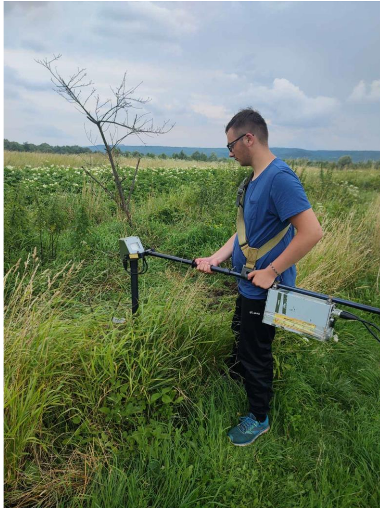
Рисунок 1.1 – Пошук ґрунтових реперів з допомогою магнітометра
